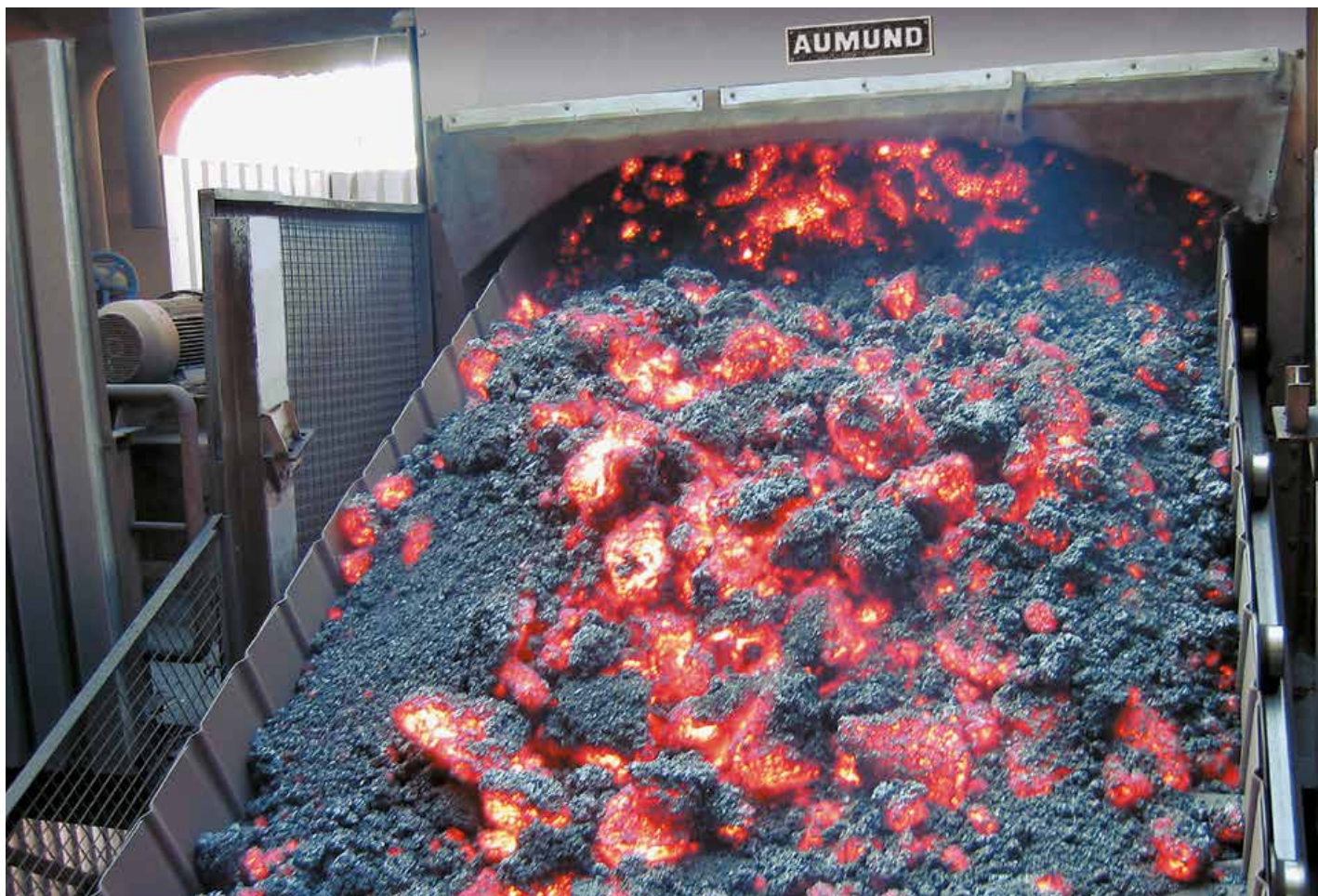
パンコンベアー KZB-S型、焼結鉱プラント、プレーメン
