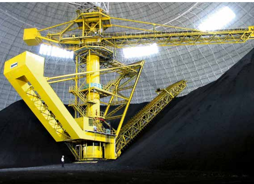
SCHADE回転型スタッカー/リクレーマーを装備する屋内ストックヤード
